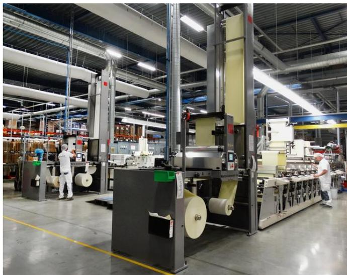
图 2: 安装于 Desmedt 的两台马汀 MBSF 对接式不停机自动放卷机, 储纸架巧妙的安装于放卷装置上方, 具有更小的体积, 并提供印刷 操作员更好的人机工程学。
