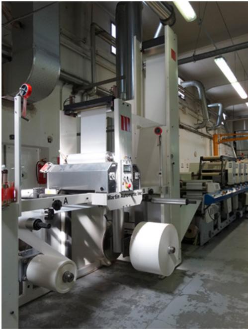
图 1：马汀 MBS 自动放卷机安装于 MPS 印刷机
