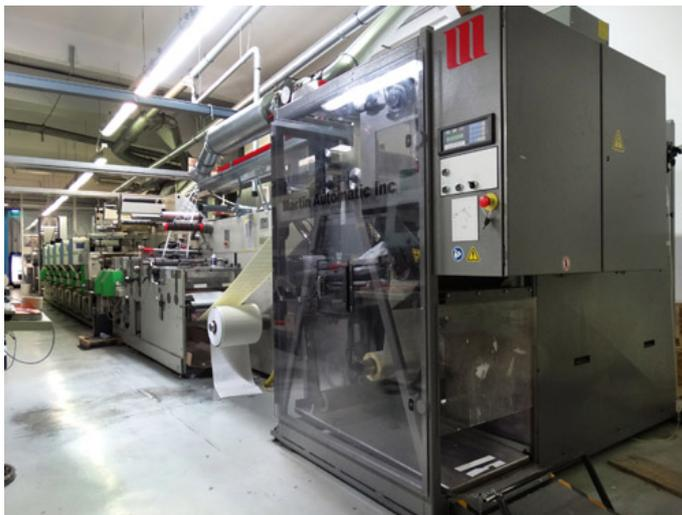
图 2：马汀 LRD 自动收卷机安装于基杜 Xpannd 印刷机
