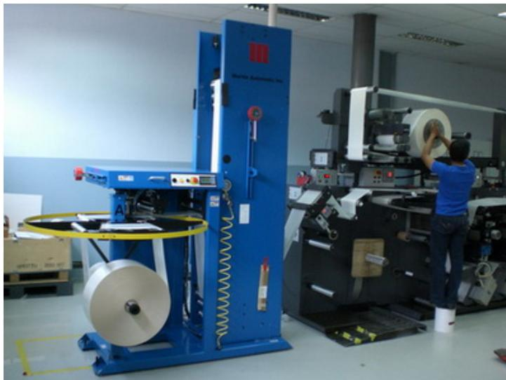
图 1: 安装在 Master Label 公司窄幅印刷机上的马汀 STS 型全自动对接式放卷机
