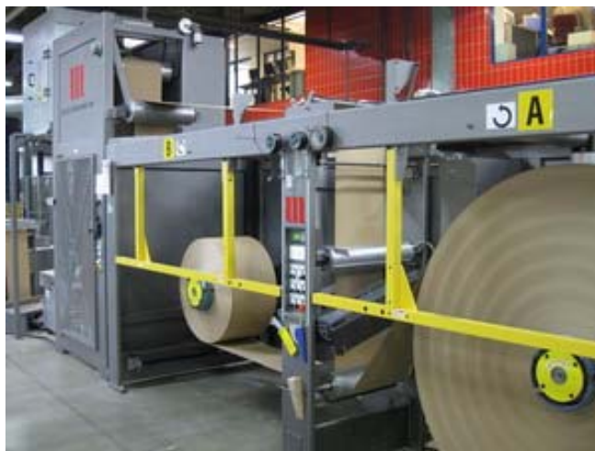
图 3. A&R 公司拥有的马汀 MBX 不停机放卷设备可使用 558mm 宽 1828mm 直径的纸卷，并提供高速不停机换卷的功能
