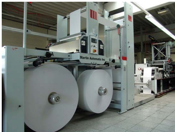
图：Novakon 公司在其麦安迪 2200 型标签印刷机上安装了马汀 MBS 全自动放卷机
